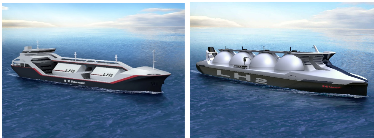
Figur 14. Kawasaki har allerede fått godkjenning for å bygge et skip for flytende hydrogen i pilot-skala (tv). Skipet forventes å settes i drift før 2020, og storskala transport i kuletankere (th) er planlagt fra 2025 (kilde: Kawasaki Heavy Industries).
